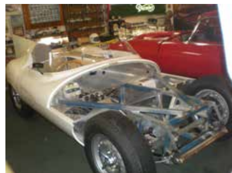
D-typen är ett nybygge från scratch med en glasfiberkaross.
